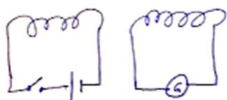
عوامل تاثیرگذار بر آزمایش: تعداد دور سیم پیچ - ولتاژ بارتری - فاصله سیم پیچ‌ها از یکدیگر - زاویه قرار گیری سیم پیچ‌ها
