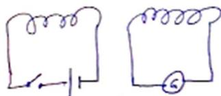
عوامل تاثیرگذار بر آزمایش: تعداد دور سیم پیچ - ولتاژ باطری - فاصله سیم پیچ ها از یکدیگر - زاویه قرار گیری سیم پیچ ها
