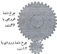
۹ در شکل مقابل اگر چرخ دنده ی ورودی را با ۱۲ دنده، ۱۲ دور کامل و بصورت ساعتگرد بچرخانیم، چرخ دنده ی بزرگ با ۳۶ دنده، چند دور و در چه جهتی می چرخد؟ ..... دور در جهت .....
