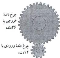
۹ در شکل مقابل اگر چرخ دنده ی ورودی را با ۱۲ دنده، ۱۲ دور کامل و بصورت ساعتگرد بچرخانیم، چرخ دنده ی بزرگ با ۳۶ دنده، چند دور و در چه جهتی می چرخد؟ ..... در جهت .....
